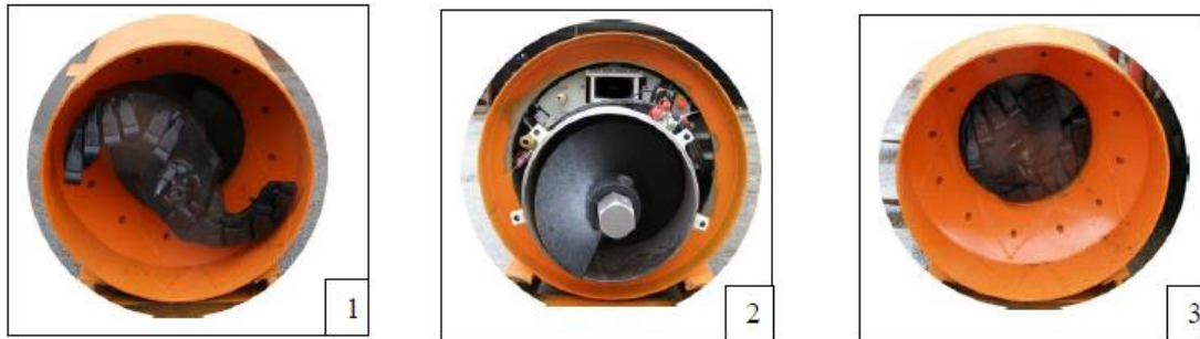
Afbeelding 2.14 - Open boorschild open (1) Afbeelding 2.15 - Achterzijde van microtunnelingsmachine (2) Afbeelding 2.16 - Gesloten boorschild (3)
